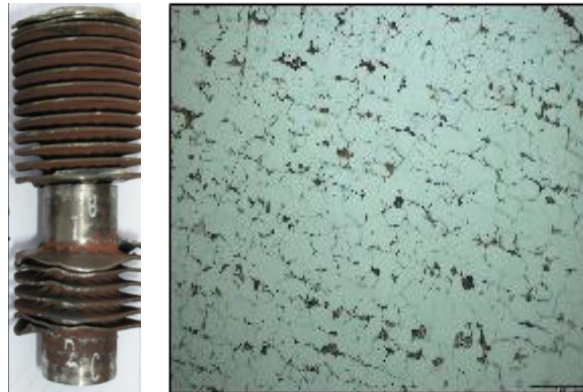
Figura 5. Material afectado por temperatura (Perlita Laminar).
