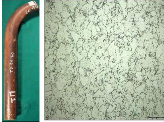
Figura 4. Material afectado por temperatura (Esferoidización).
